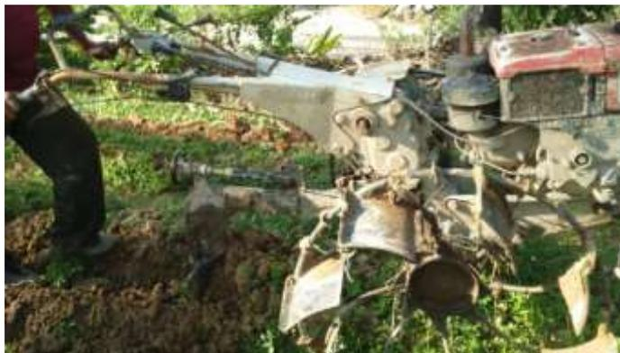
Gambar 1. Pengolahan tanah dengan *handtractor*
